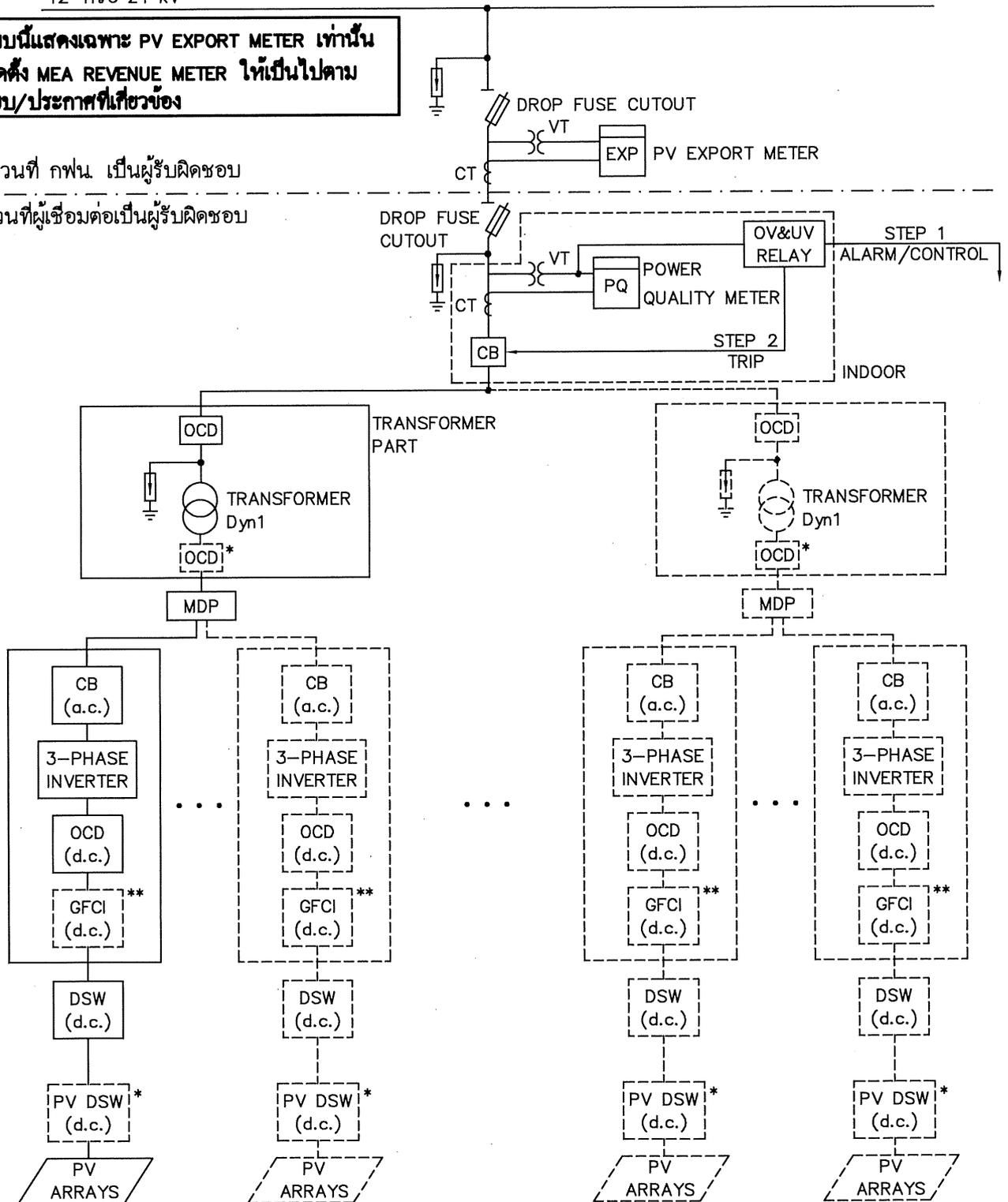
สัญลักษณ์/คำย่อ    OCD = OVERCURRENT DEVICE (FUSE OR CB)
