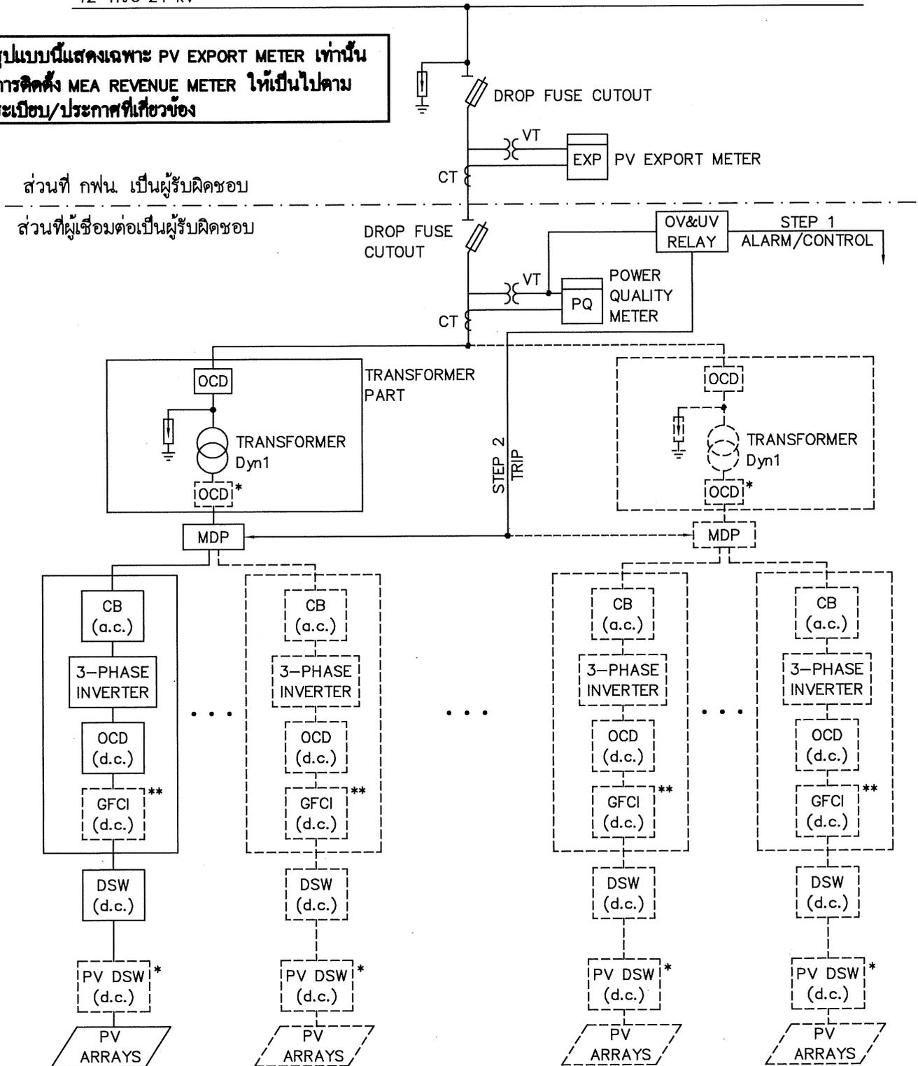
สัญลักษณ์/คำย่อ OCD = OVERCURRENT DEVICE (FUSE OR CB)
